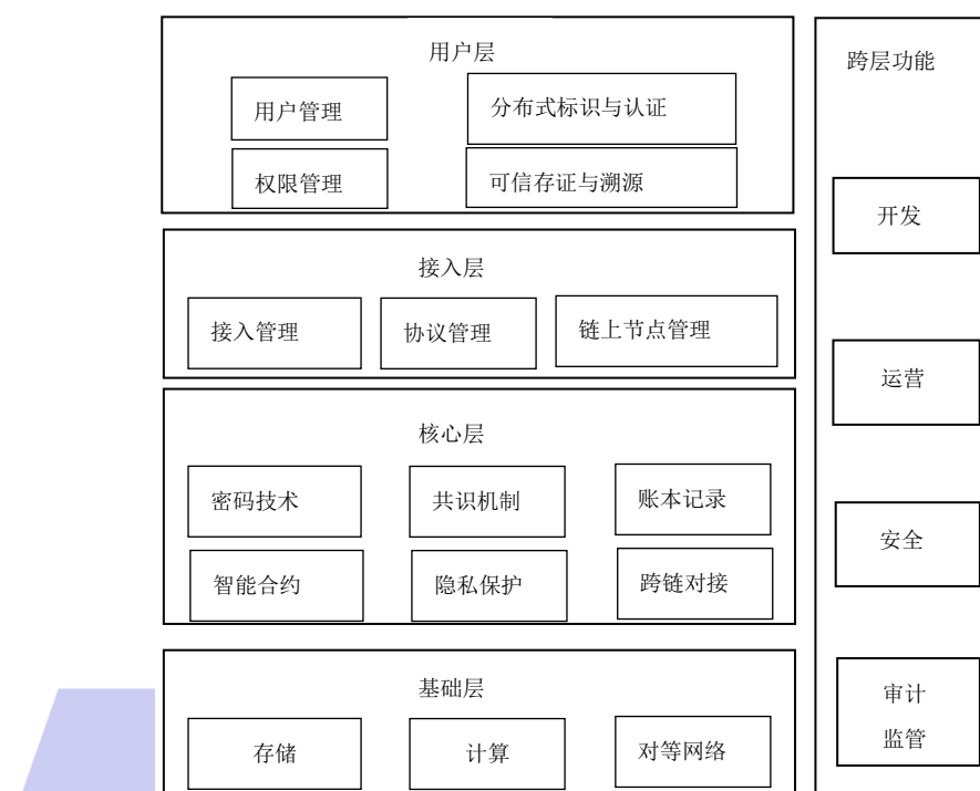
图2 基于区块链技术的冷链物流可信溯源服务分层框架
